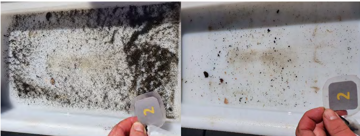
Figur 7: Bilder som viser sedimentet fra stasjon 2 før og etter siling. Sedimentet besto av silt. Foto: Aqua Kompetanse AS.
