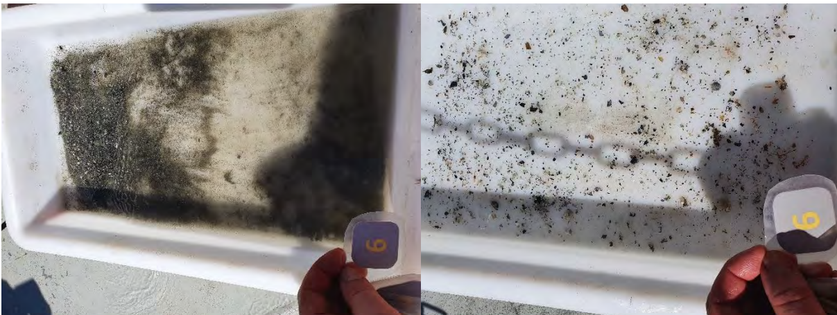
Figur 11: Bilder som viser sedimentet fra stasjon 6 før og etter siling. Sedimentet besto av sand og skjellsand. Foto: Aqua Kompetanse AS.
