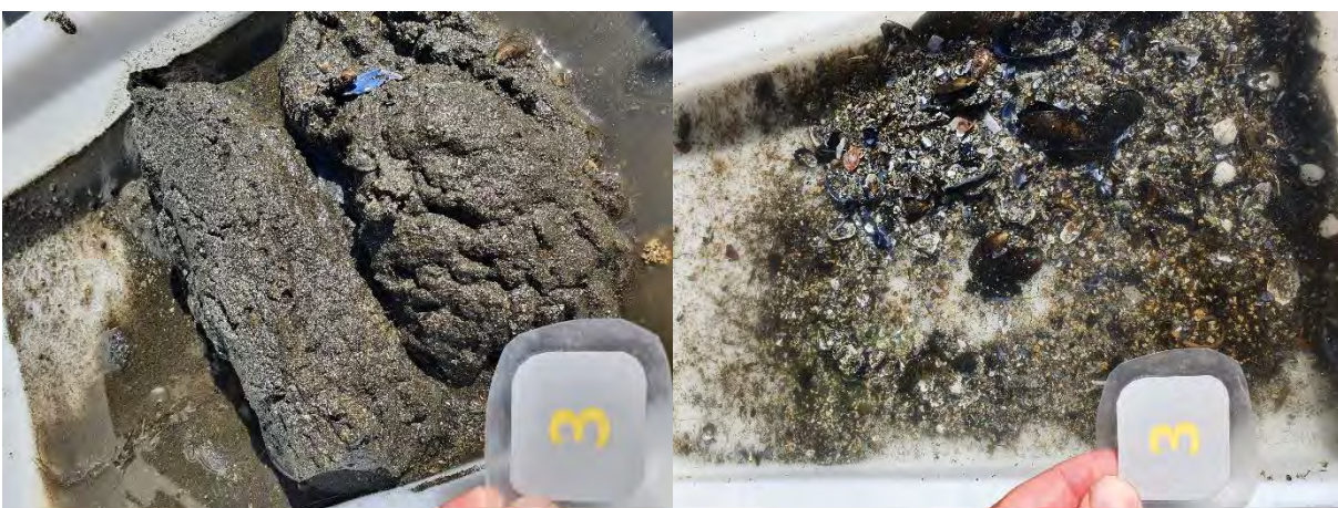
Figur 8: Bilder som viser sedimentet fra stasjon 3 før og etter siling. Sedimentet besto av sand og skjellsand. Det ble registrert fôrrester i denne prøven. Foto: Aqua Kompetanse AS.
