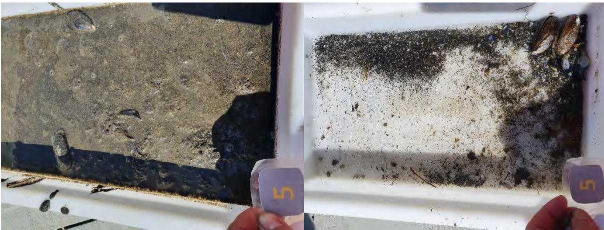
Figur 10: Bilder som viser sedimentet fra stasjon 5 før og etter siling. Sedimentet besto av silt og sand. Foto: Aqua Kompetanse AS.
