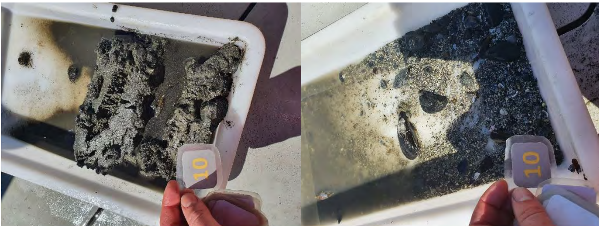
Figur 14: Bilder som viser sedimentet fra stasjon 10 før og etter siling. Sedimentet besto av silt og skjellsand. Foto: Aqua Kompetanse AS.
