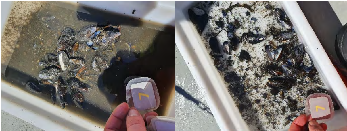
Figur 12: Bilder som viser sedimentet fra stasjon 7 før og etter siling. Sedimentet besto av silt. Det ble registrert fôrrester og fekalier i denne prøven. Foto: Aqua Kompetanse AS.
