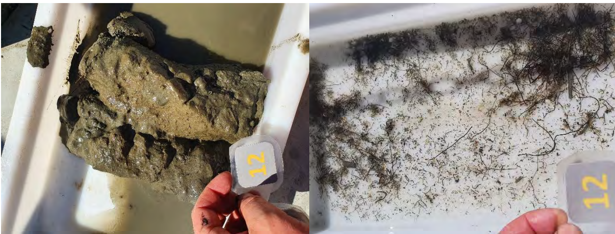
Figur 16: Bilder som viser sedimentet fra ekstrastasjon 12 før og etter siling. Sedimentet besto av silt. Foto: Aqua Kompetanse AS.
