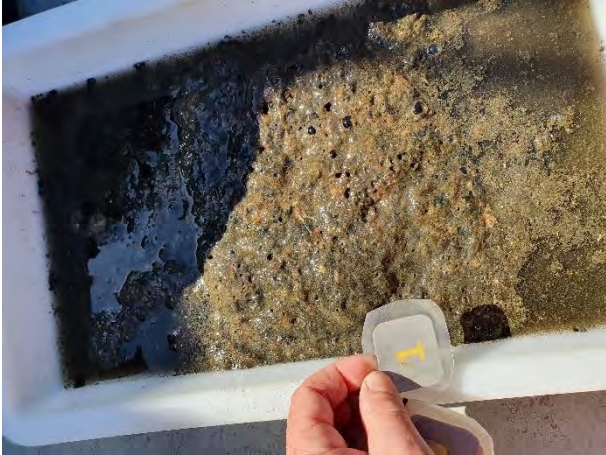
Figur 6: Bilder som viser sedimentet fra stasjon 1 før siling. Sedimentet besto av et slamlag. Det ble registrert fôrrester og fekalier i denne prøven. Denne prøven ble ikke siktet pga. sterk gassutvikling i prøven. Foto: Aqua Kompetanse AS.
