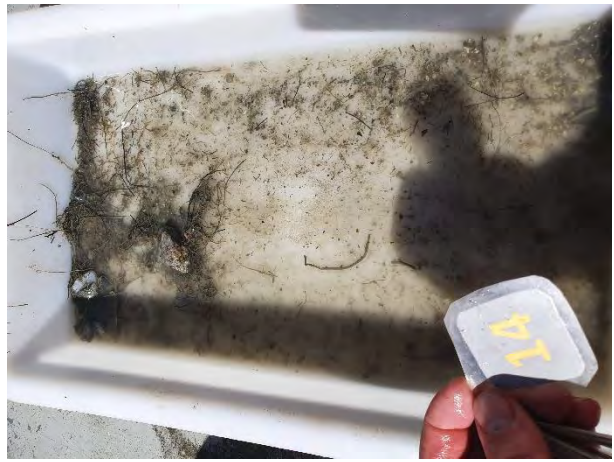
Figur 18: Bilder som viser sedimentet fra ekstrastasjon 14 før og etter siling. Sedimentet besto av silt. Foto: Aqua Kompetanse AS.
