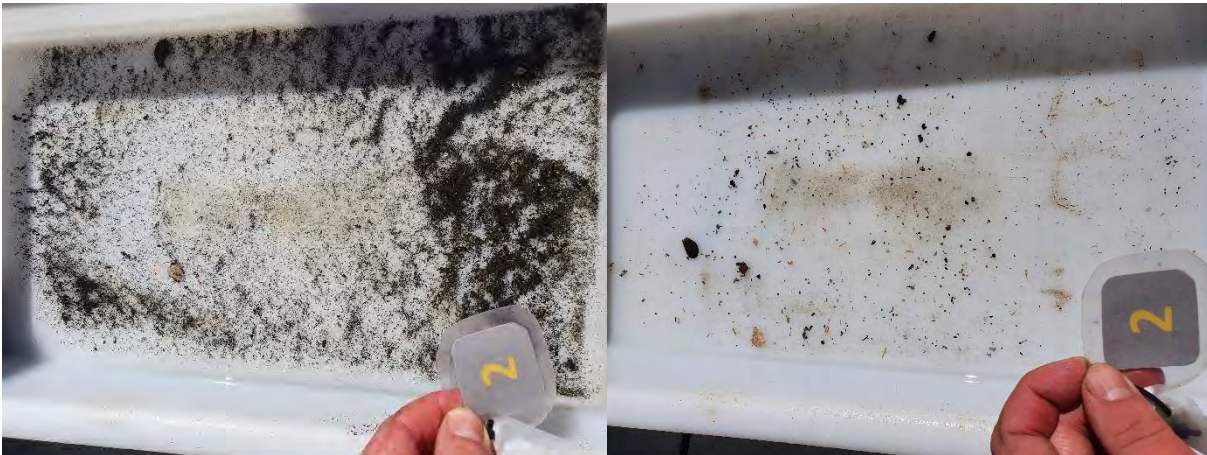
Figur 7: Bilder som viser sedimentet fra stasjon 2 før og etter siling. Sedimentet besto av silt. Foto: Aqua Kompetanse AS.
