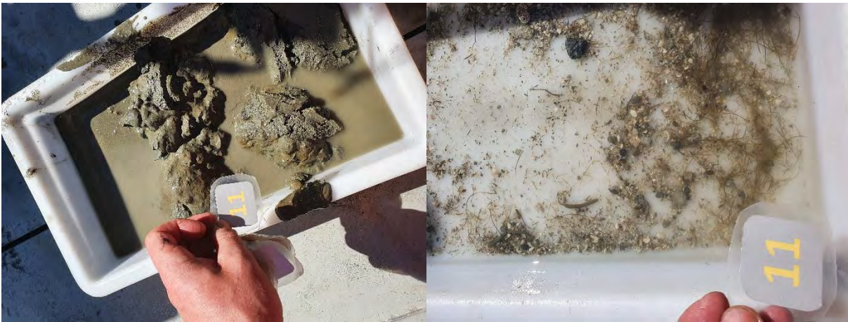
Figur 15: Bilder som viser sedimentet fra ekstrastasjon 11 før og etter siling. Sedimentet besto av silt og skjellsand. Foto: Aqua Kompetanse AS.
