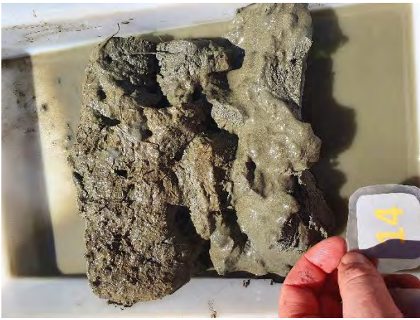
Figur 18: Bilder som viser sedimentet fra ekstrastasjon 14 før og etter siling. Sedimentet besto av silt. Foto: Aqua Kompetanse AS.
