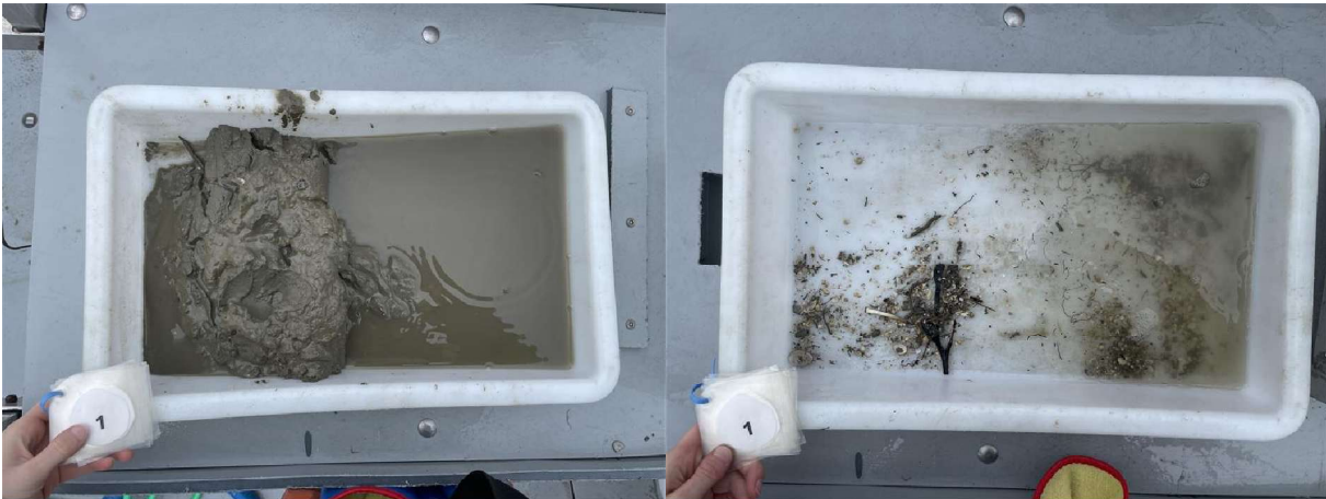
Figur 6: Bilder som viser sedimentet fra stasjon 1 før og etter siling. Sedimentet besto av leire og silt. Foto: Aqua Kompetanse AS.
