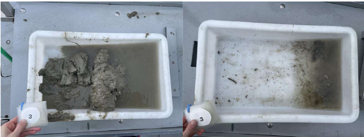
Figur 8: Bilder som viser sedimentet fra stasjon 3 før og etter siling. Sedimentet besto av leire og silt. Foto: Aqua Kompetanse AS.
