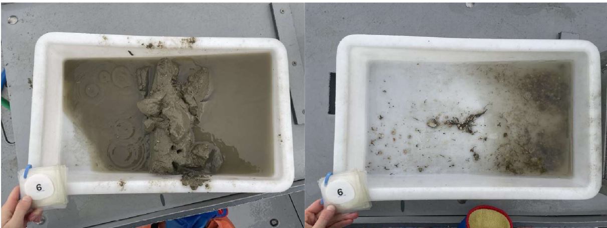
Figur 11: Bilder som viser sedimentet fra stasjon 6 før og etter siling. Sedimentet besto av leire, silt og sand. Foto: Aqua Kompetanse AS.
