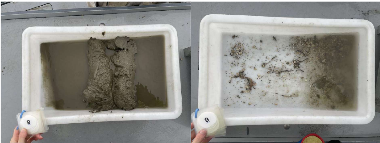
Figur 14: Bilder som viser sedimentet fra stasjon 9 før og etter siling. Sedimentet besto av silt og leire. Foto: Aqua Kompetanse AS.
