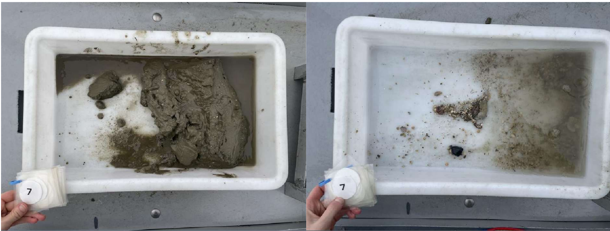
Figur 12: Bilder som viser sedimentet fra stasjon 7 før og etter siling. Sedimentet besto av leire, silt og sand. Foto: Aqua Kompetanse AS.
