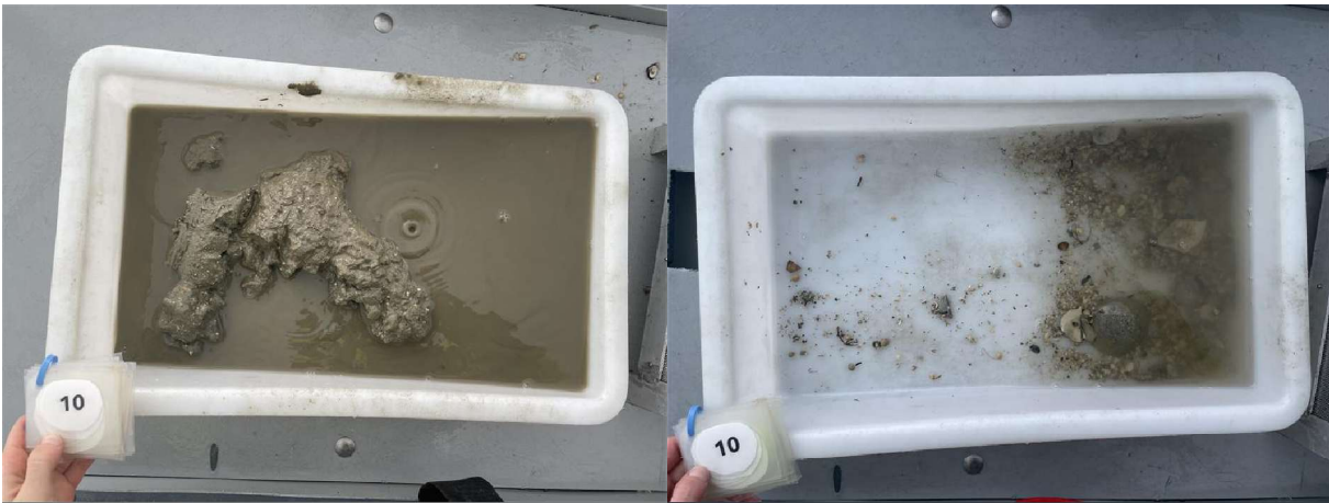
Figur 15: Bilder som viser sedimentet fra stasjon 10 før og etter siling. Sedimentet besto av leire, silt og skjellsand. Foto: Aqua Kompetanse AS.
