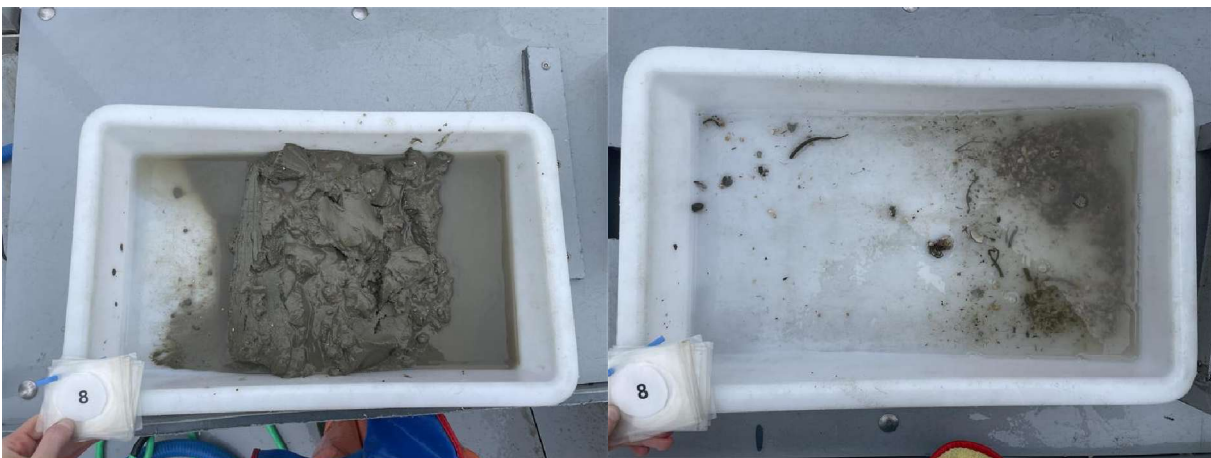
Figur 13: Bilder som viser sedimentet fra stasjon 8 før og etter siling. Sedimentet besto av silt og leire. Foto: Aqua Kompetanse AS.
