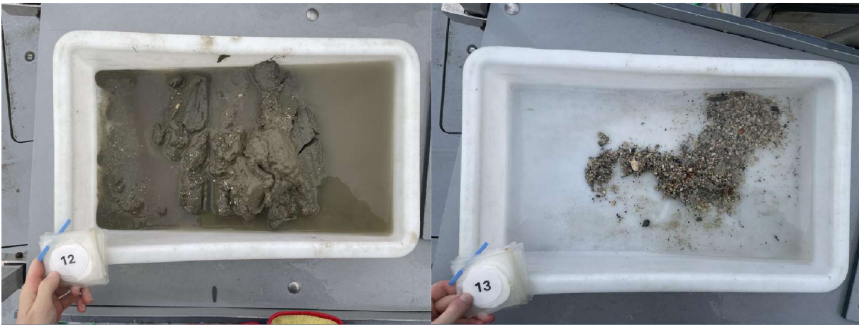
Figur 18: Bilder som viser sedimentet fra stasjon 13 før og etter siling. Bildet før siling er feilmerket i felt. Sedimentet besto av leire, silt og skjellsand. Foto: Aqua Kompetanse AS.
