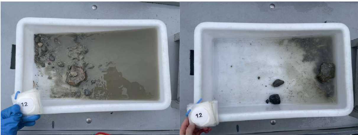
Figur 17: Bilder som viser sedimentet fra stasjon 12 før og etter siling. Sedimentet besto av leire og grus. Foto: Aqua Kompetanse AS.
