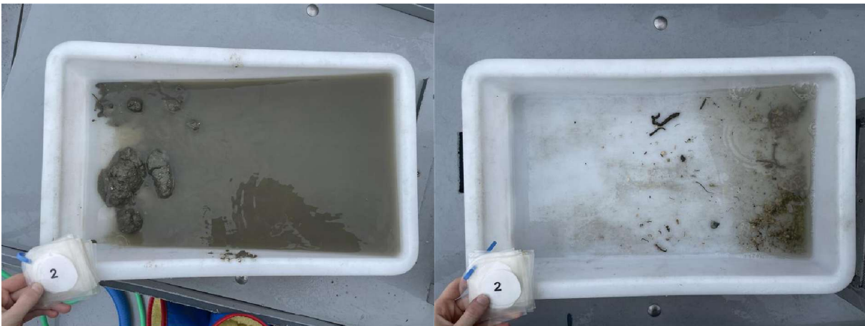
Figur 7: Bilder som viser sedimentet fra stasjon 2 før og etter siling. Sedimentet besto av leire og silt. Foto: Aqua Kompetanse AS.
