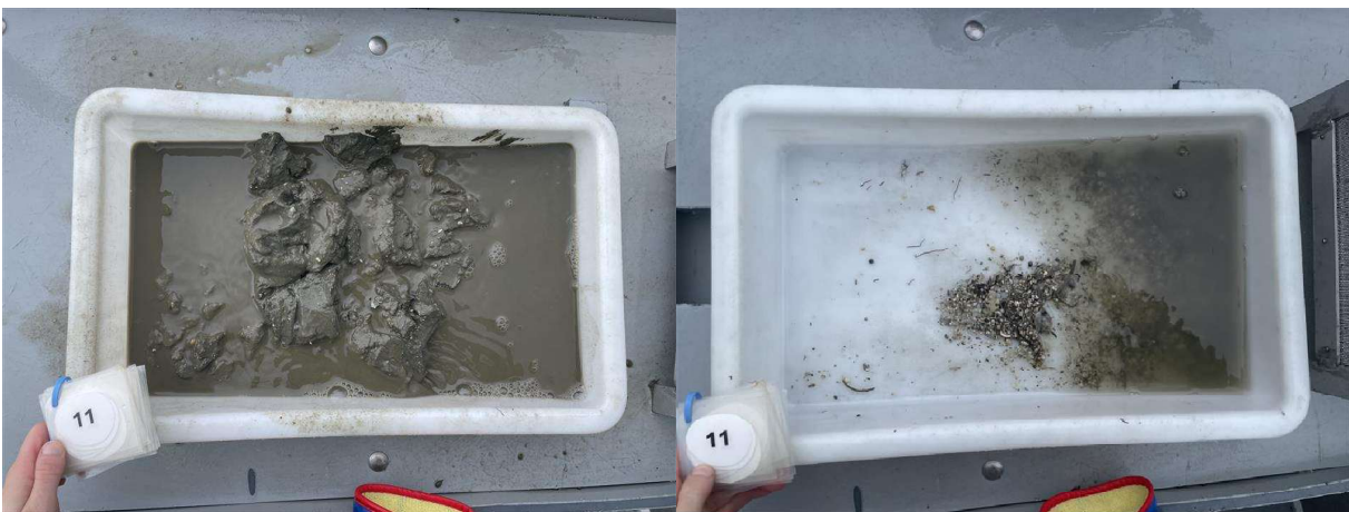
Figur 16: Bilder som viser sedimentet fra stasjon 11 før og etter siling. Sedimentet besto av leire, silt og skjellsand. Foto: Aqua Kompetanse AS.
