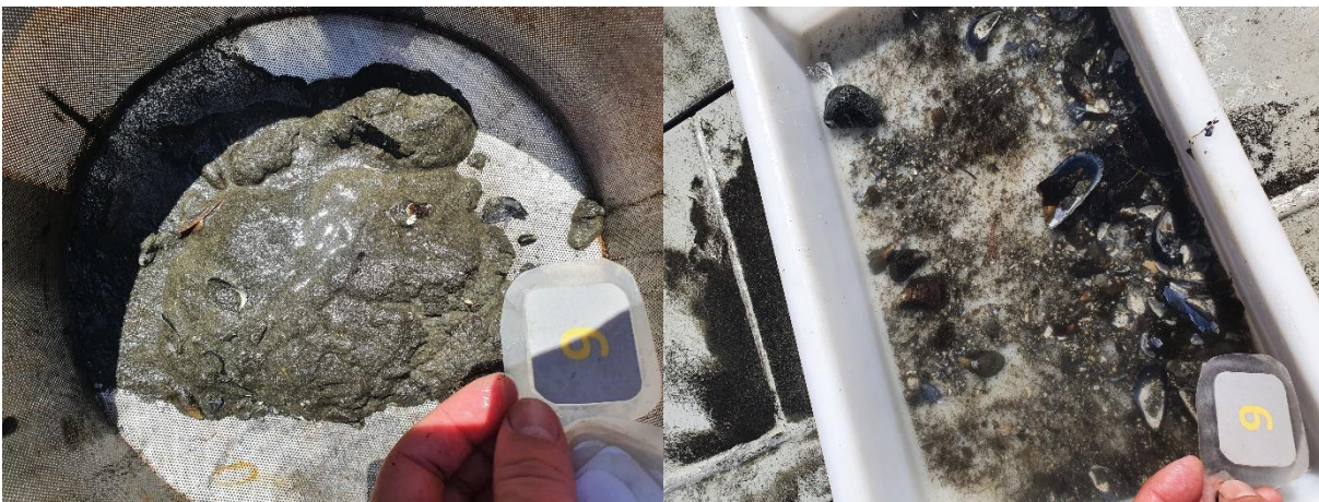
Figur 13: Bilder som viser sedimentet fra stasjon 9 før og etter siling. Sedimentet besto av silt, sand og grus. Foto: Aqua Kompetanse AS.
