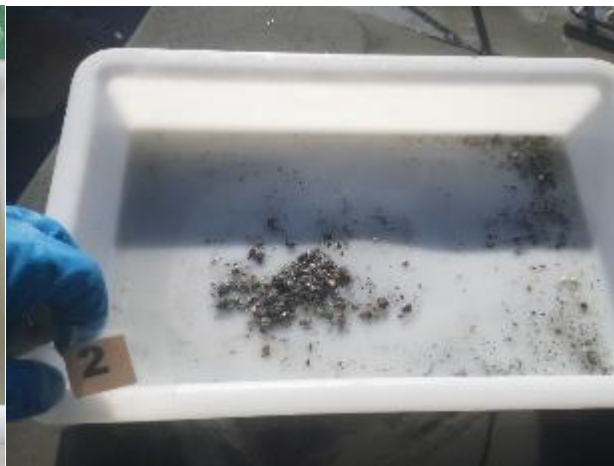
Figur 7: Bilder som viser sedimentet fra stasjon 2 før og etter siling. Sedimentet besto av leire og noe sand. Foto: Aqua Kompetanse AS.
