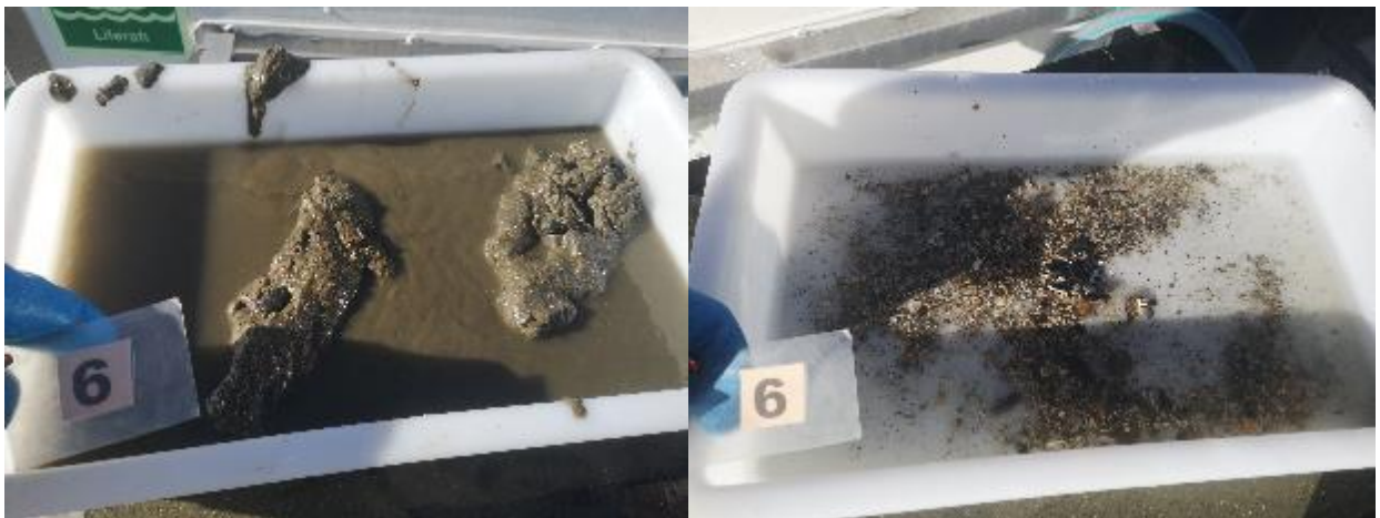
Figur 11: Bilder som viser sedimentet fra stasjon 6 før og etter siling. Sedimentet besto av silt og noe sand. Foto: Aqua Kompetanse AS.
