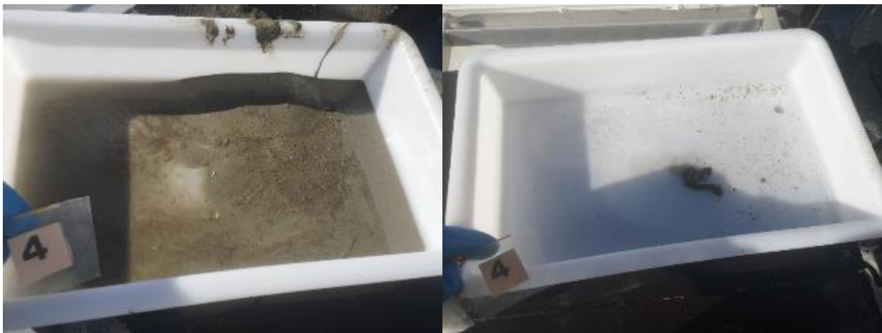
Figur 9: Bilder som viser sedimentet fra stasjon 4 før og etter siling. Sedimentet besto av sand og noe silt og leire. Foto: Aqua Kompetanse AS.
