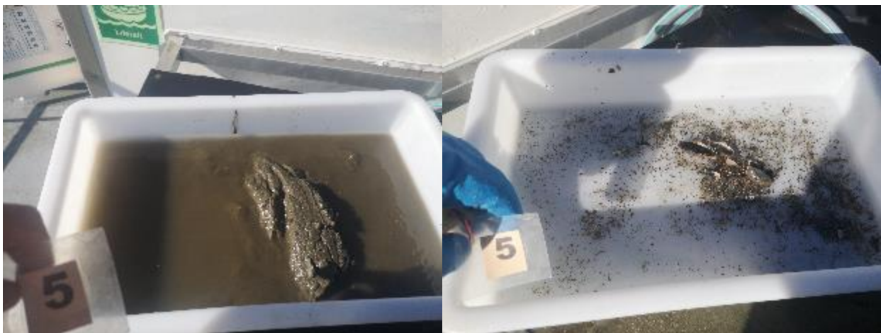
Figur 10: Bilder som viser sedimentet fra stasjon 5 før og etter siling. Sedimentet besto av silt og noe sand. Foto: Aqua Kompetanse AS.
