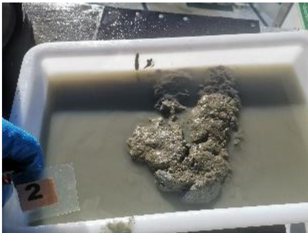
Figur 7: Bilder som viser sedimentet fra stasjon 2 før og etter siling. Sedimentet besto av leire og noe sand. Foto: Aqua Kompetanse AS.
